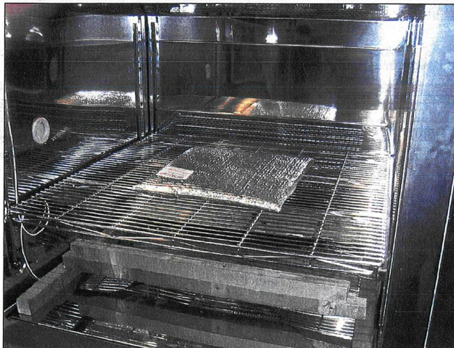
Abb. 1: Probe im Klimaschrank
