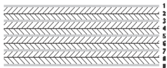
Abb. 2 Vereinfachte schematische Anordnung der hybriden Folie Lu.po.Therm B2+8 , die aus 8 Luftpolsterfolien (schraffierte Schichten) und aus 5 Aluminiumfolien (graue horizontale Striche) in den ungeraden Positionen besteht. In den geraden Positionen befindet sich die Luftpolsterfolie aus HD-PE.
